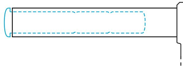
As outras dimensões que caracterizam o dispositivo são os diâmetros do corpo (18,5 mm), da cabeça (23 mm) e da tampa (25 mm).
